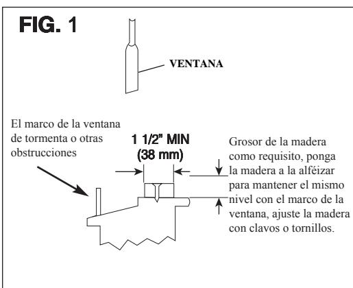
Si el marco de la ventana se hay que quedar, asegúrese de que el agujero del desague o las hendiduras no esten calafateadas o muy pintadas. El agua de lluvia o condensación se debe drenar afuera.
